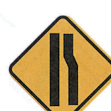
A - 21c ESTREITAMENTO DE PISTA À DIREITA
